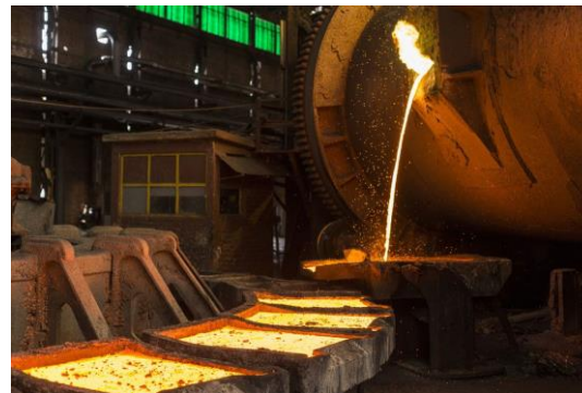
구리 정광의 건식 제련을 통한 정제조동 제조 과정
