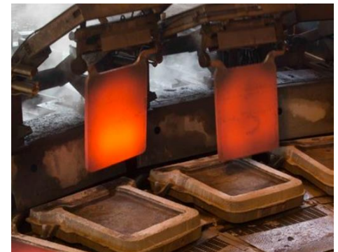
구리 정광의 건식 제련을 통한 정제조동 제조 과정
